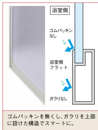
**上枠換気構造**▶
