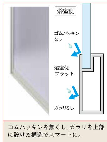
**上枠換気構造**▶
