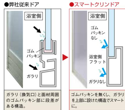
ガラリ（換気口）と面材周囲のゴムパッキン部に段差がある構造。
